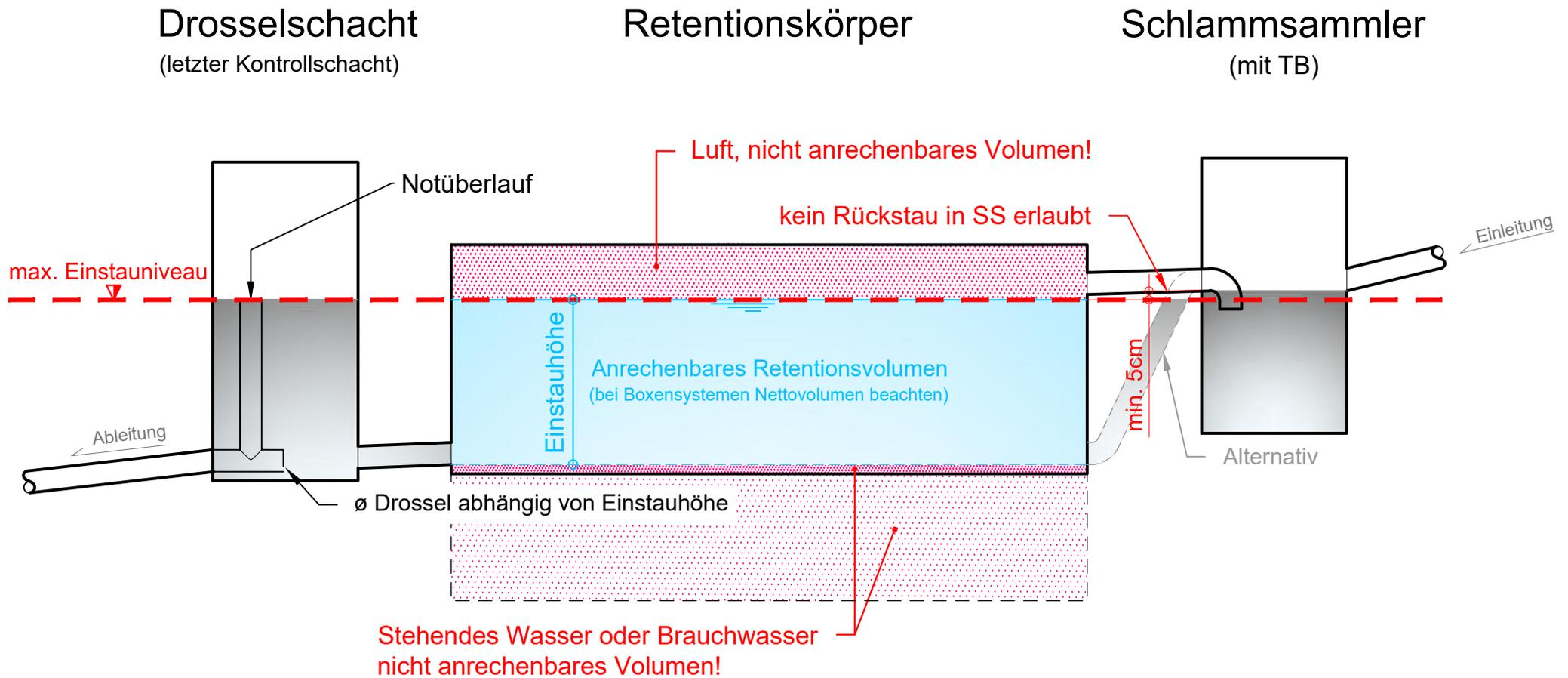
max. Einstauniveau = Höhe Auslauf SS -5cm = Höhe Notüberlauf
